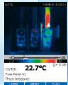
La diferencia de temperatura entre fases indica una carga desequilibrada
